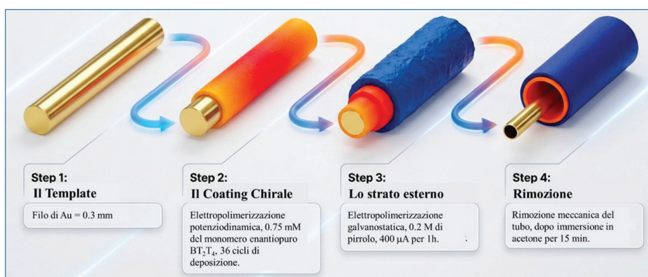
Fig. 1 - Step per la fabbricazione dei dispositivi tubolari miniaturizzati attraverso una procedura sequenziale basata sull'elettrodeposizione di polimeri conduttori su un template metallico
