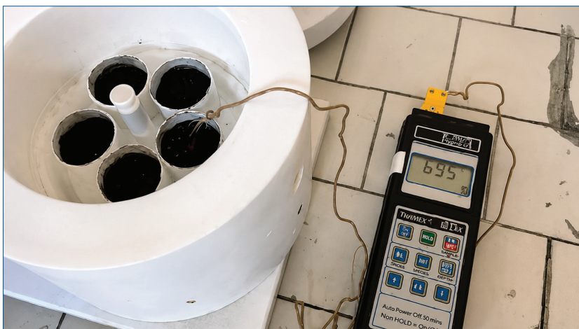
Fig. 1 - Trattamento termico a microonde di black mass da batterie esauste (Università di Brescia/INSTM)
