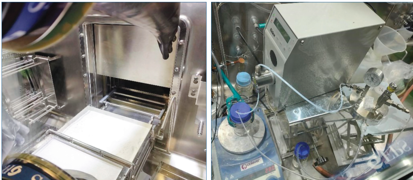
Fig. 4 - Alcune tecniche impiegate per la purificazione e l'isolamento di PL in Procos SpA: la liofilizzazione e la nanofiltrazione
