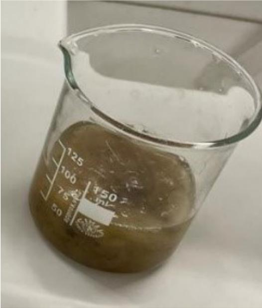
**Figura 3.** Lana dopo l'estrazione (<https://www.science-on-stage.eu/material/3-rs-keratin>)
