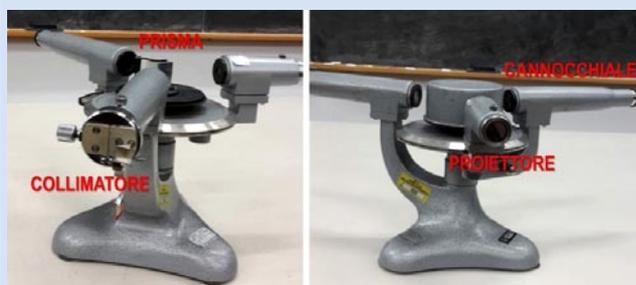
**Fig. 2** Spettroscopio didattico utilizzato nel percorso 1
