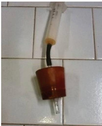
**Foto 2-** Tappo con pipetta da 2 mL per la beuta A
