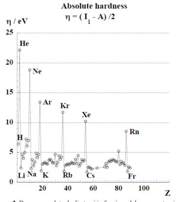
Figura 2. Durezza assoluta degli atomi in funzione del numero atomico
