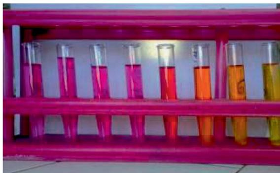
**Figura 4.** Variazione del colore della soluzione di rosso metile a differenti valori del pH
