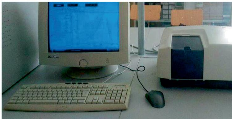
**Figura 6.** Spettrofotometro-UV/V-630 della Jasco.
