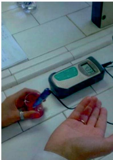
**Figura 5.** Misurazione del pH di una delle soluzioni tampone
