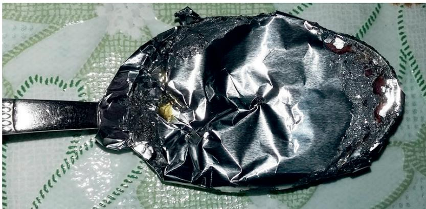
**Figura 3.** La pellicola di alluminio si è ossidata e il ferro del cucchiaino si è ridotto (l'acciaio è una lega di ferro e carbonio).
