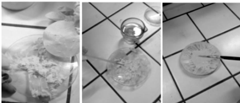
**Figura 2:** Preparazione del colore giallo  $\text{PbI}_2$  da stendere su foglio
