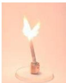
**Figura 27.** Fotogramma del filmato di combustione del fil di ferro in una beuta satura di ossigeno.
