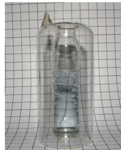
**Figura 25.** Ossigeno liquido in Dewar trasparente.
