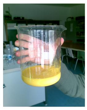
Fig. 2 -Il solido giallo decanta sul fondo
