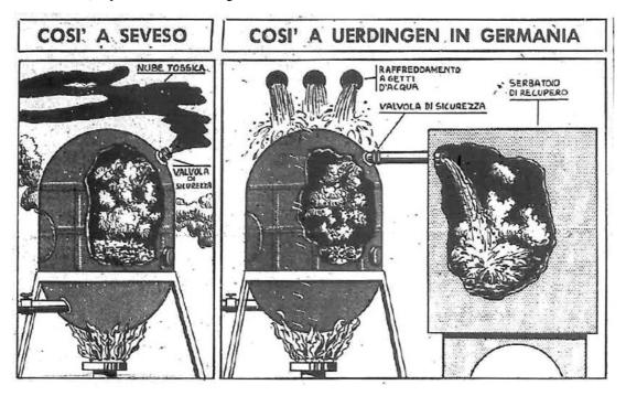
**Figura 4.** Confronto fra l'impianto Icmesa di produzione del triclorofenolo e quello della Bayer di Uerdingen. *Corriere della Sera*, 29 Agosto 1976, pagina 7.
