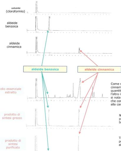
Con microsiringa viene introdotta nel gascromatografo una quantità di campione (dell'ordine di 0,2 µL).
