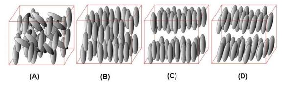
**Figura 2.** Principali tipi di mesofasi liquido cristalline termotropiche di un mesogeno molecolare calamitico "standard", ordinate da sinistra a destra in funzione del crescente ordine al loro interno (temperatura decrescente): (A) fase liquida isotropa (I), (B) fase nematica (N), (C) fase smettica A (SmA) e (D) fase smettica C (SmC).
