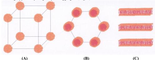
**Figura 8.** Principali tipi di mesofasi liotropiche formate da aggregati di tensioattivi in soluzione già riportati in fig. 7: da sinistra verso destra: fase cubica (composta di micelle), fase esagonale (composta da cilindri), fase lamellare (composta da doppi strati). Tutte le mesofasi mostrate in figura mostrano ordine posizionale al loro interno.
