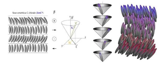
**Figura 4.** Fase smettica C chirale  $(SmC^*)$ . A sinistra e a destra, due diverse visualizzazioni dell'allineamento dei mesogeni in strati smettici consecutivi (il vettore di polarizzazione P è indicato per ogni piano smettico); al centro, due schematizzazioni della soprastruttura elicoidale.
