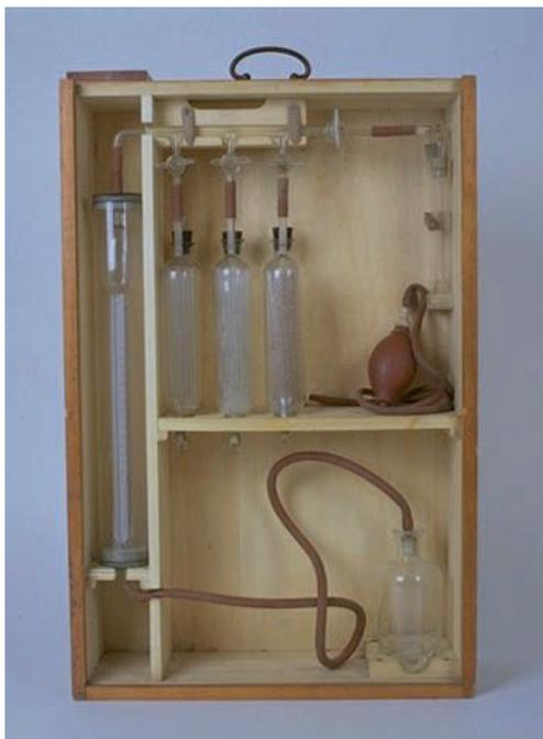
**Figura 9:** *Strumento per analisi volumetrica presso il CUTVAP di Siena.*
