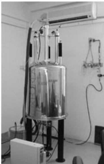
**Figura 10:** Esempio di spettrometro NMR per stato solido.
