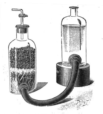
Appareil pour la preparation continue de l'hydrogène
