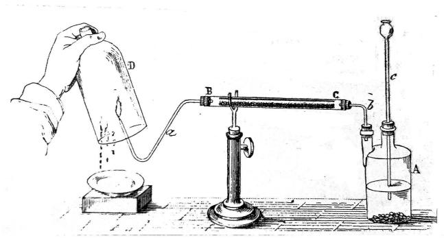
Production de la vapeur d'eau par la combustion de l'hydrogène
