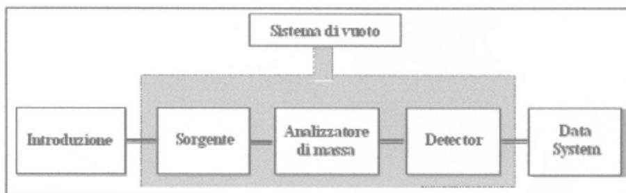
Figura 1. Schema a blocchi di uno spettrometro di massa.
