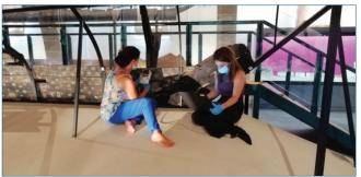
Fig. 1 - Indagini mediante spettoscopia XRF dei chiodi della nave punica conservata presso il Parco Archeologico Lilibeo-Marsala
