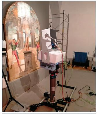
Fig. 3 - Il sistema "Bruker HI90 modificato" durante una misura di imaging iperspettrale nel medio-IR sul dipinto di Pietro Perugino "Il martirio di S. Sebastiano" (1518), in restauro presso la Galleria Nazionale dell'Umbria
