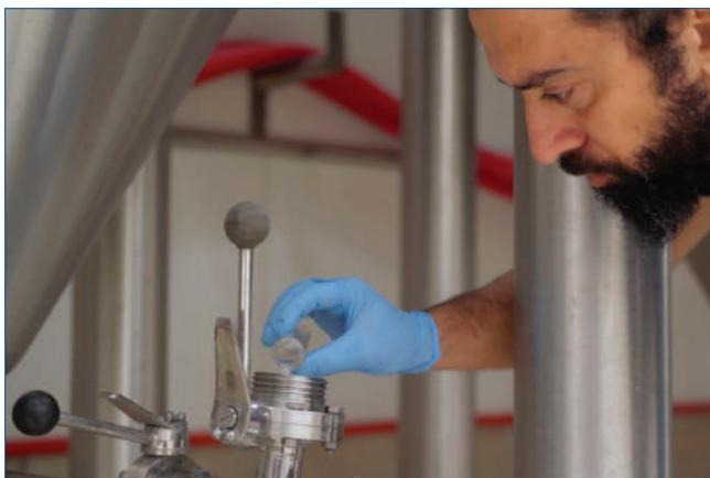
Fig. 7 - Aggiunta di estratto di luppolo nel fermentatore
