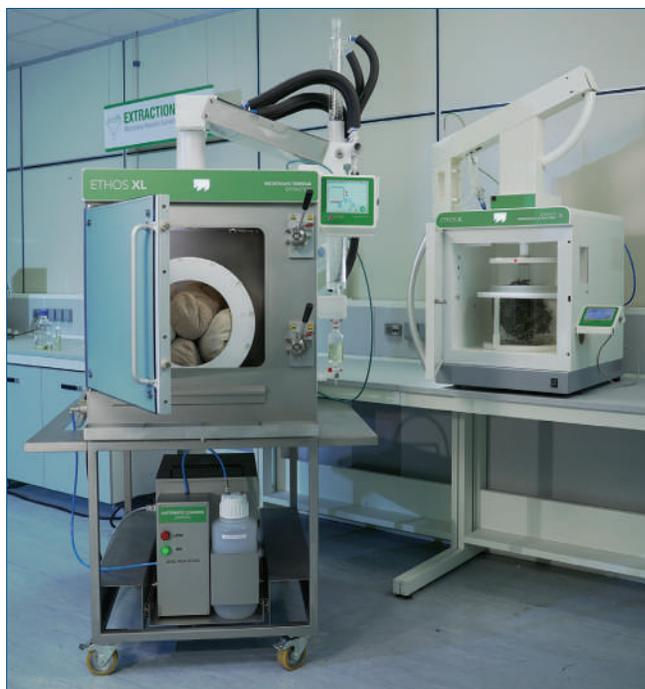
Fig. 1 - Milestone Ethos X 2.0 e Ethos XL, due esempi di strumenti a microonde per la distillazione di olii essenziali da prodotti naturali per finalità produttive
