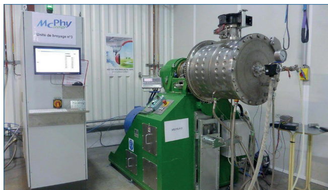
Fig. 3 - Sistema rotante di tipo Simoloyer ( https://gmbh.zoz.de/?page_id=1072 )
