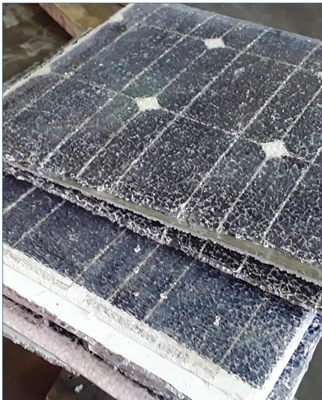
Fig. 1 - Pannelli fotovoltaici a fine vita
