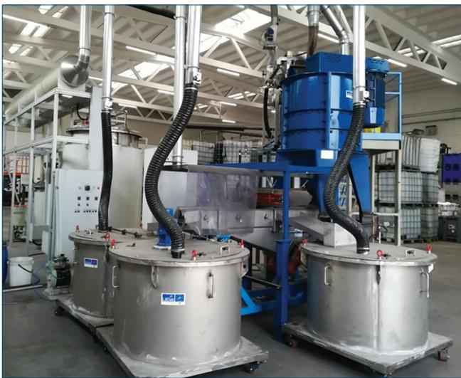
Fig. 6 - Impianto prototipo LiBat: sezione meccanica
