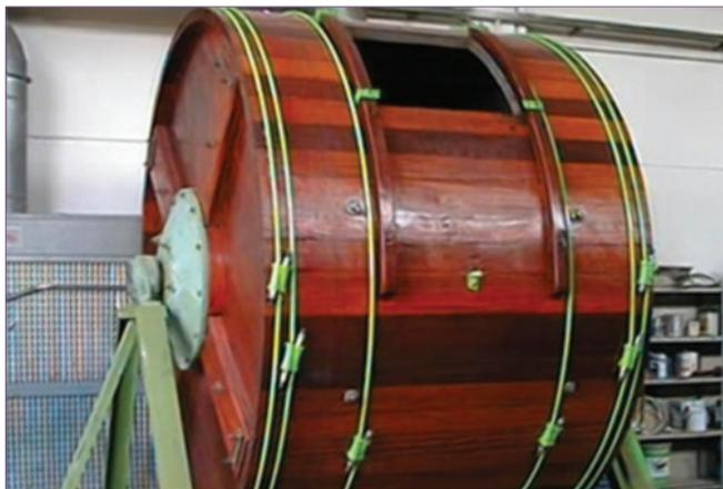
Fig. 2 -Bottale generalmente impiegato durante il processo di concia
