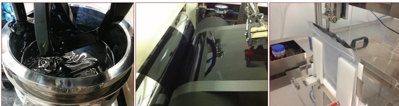
Fig. 1 - Foto scattate durante la produzione di celle litio-ione sulla linea pilota di Lithops
