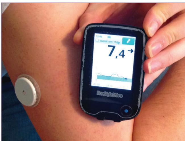
Fig. 4 - Dispositivo impiantabile per la misura della glicemia
