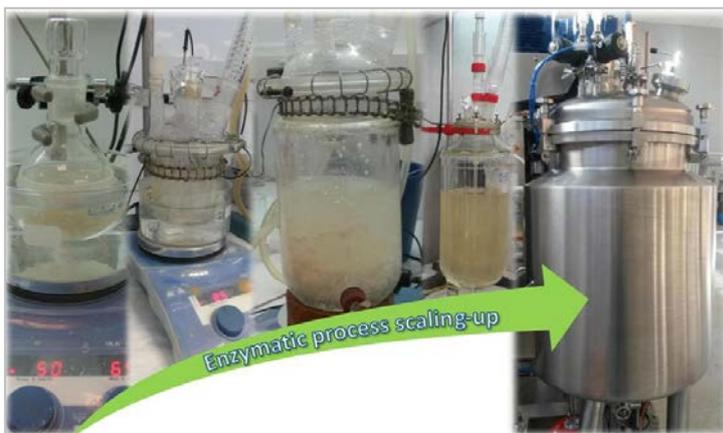
liquido-solido); reazioni dove si devono ottenere dei solidi. Lo scale-up di un processo è parte integrante dell'innovazione ed è alla base del successo e del fallimento di un processo. Sono stati esaminati tre aspetti dello scale-up: le diverse fasi a partire dal laboratorio; alcuni aspetti di cambiamento della chimica nelle diverse fasi; i problemi di sicurezza che nascono nelle scale-up.
