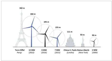
Fig. 11 - La potenza delle turbine eoliche aumenta all'aumentare delle dimensioni.
