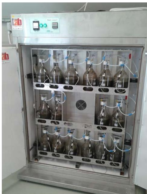
Fig. 4 - Sistema di determinazione del potenziale metanigeno (BMP) in batch
