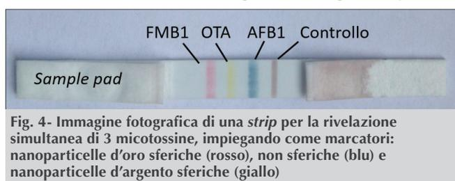
Fig. 4 - Immagine fotografica di una *strip* per la rivelazione simultanea di 3 micotossine, impiegando come marcatori: nanoparticelle d'oro sferiche (rosso), non sferiche (blu) e nanoparticelle d'argento sferiche (giallo)
