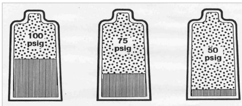
Fig. 1 - Aerosol con gas compresso
