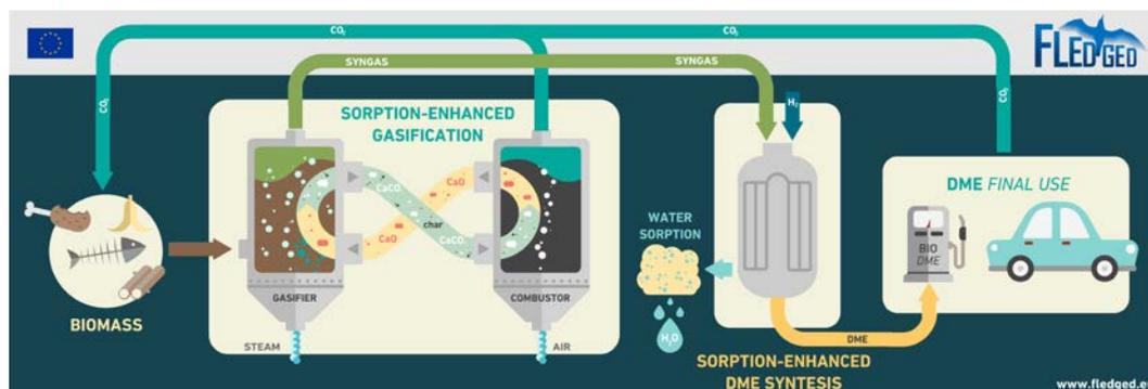
*Il concept del progetto FLEDGED: dalla biomassa al biocombustibile tramite un processo reso più efficiente dall'uso di sorbenti*
