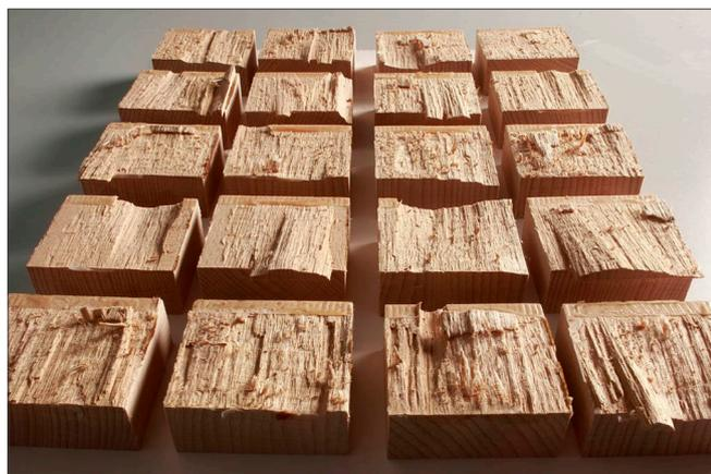
Fig. 3 - Prova di sfibramento del legno in prossimità del giunto incollato, per valutare la forza dell'adesivo
