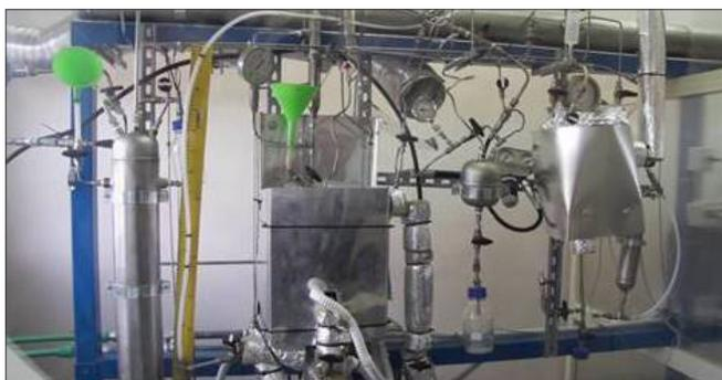
Fig. 2 - Particolare di prototipo per la produzione di biofuel da oli esausti di frittura
