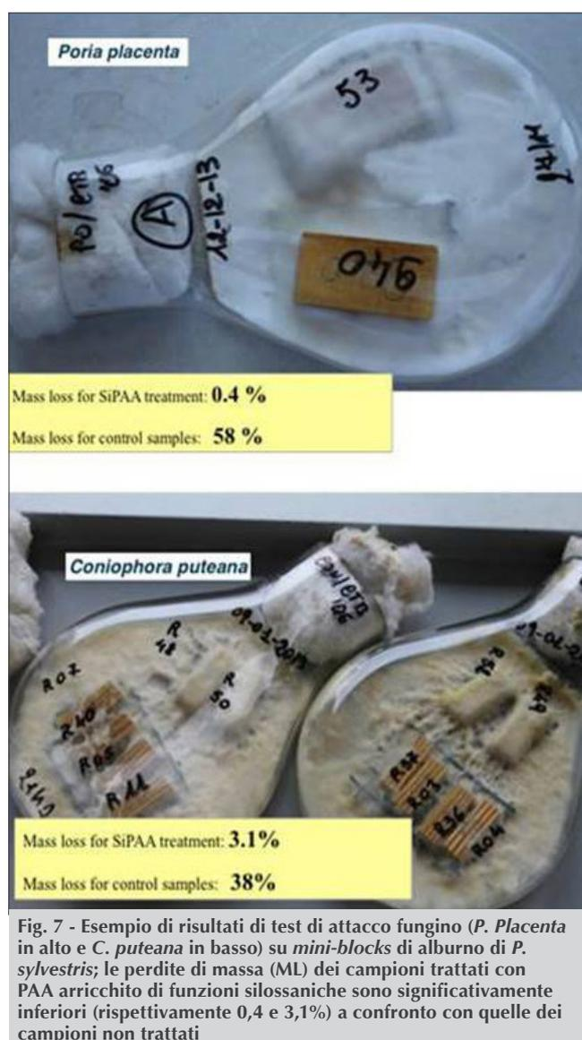
Fig. 7 - Esempio di risultati di test di attacco fungino (*P. Placenta* in alto e *C. puteana* in basso) su *mini-blocks* di alburno di *P. sylvestris*; le perdite di massa (ML) dei campioni trattati con PAA arricchito di funzioni silossaniche sono significativamente inferiori (rispettivamente 0,4 e 3,1%) a confronto con quelle dei campioni non trattati
