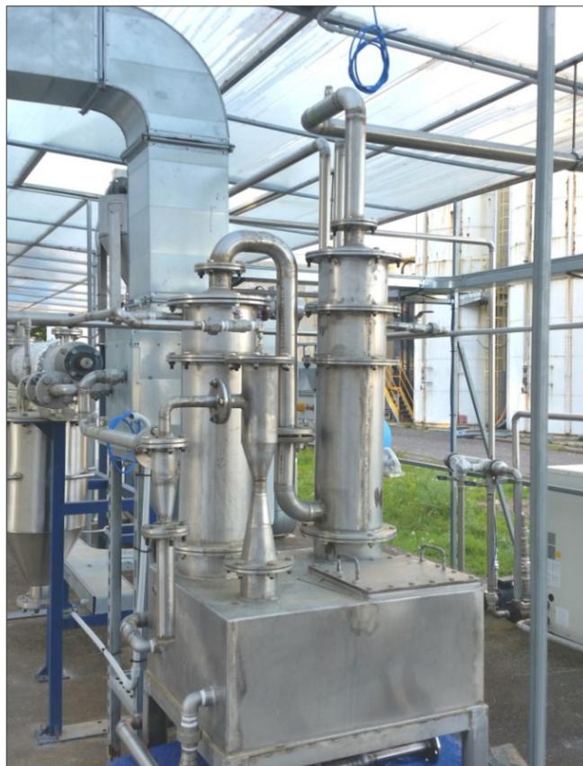
Fig. 8 - Impianto prototipo di condensazione per la separazione dell'olio di pirolisi
