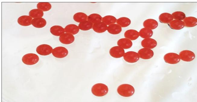
Fig. 3 - Sferette di alginato ottenute incapsulando il 5% (p/v) di residuo liofilizzato
