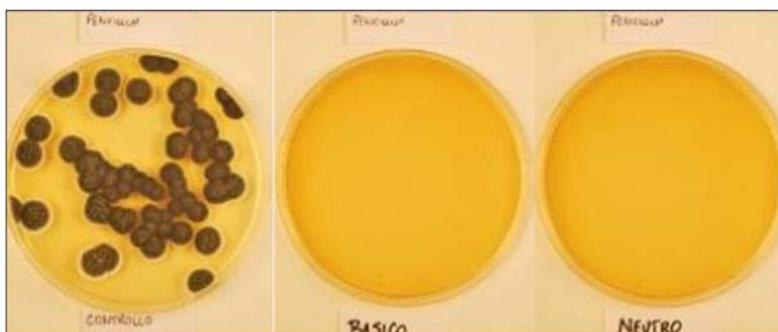
Fig. 12 - Confronto fra la germinazione di spore di *Eurotium chevalieri* su terreno di coltura MEA (*malt extract agar*) in assenza (CONTROLLO) e in presenza di PAAOH 0,15 M tal quale (BASICO) e neutralizzato con acido fosforico (NEUTRO). È evidente la totale inibizione esercitata dalla poliamidoammina
