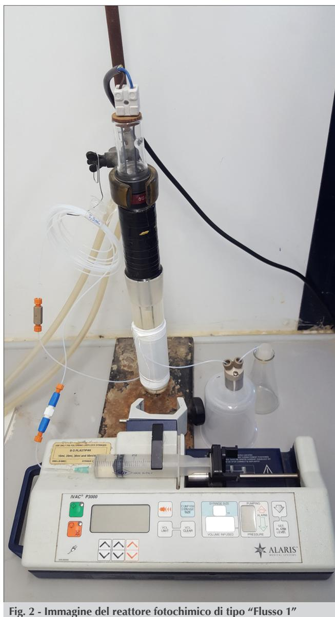
Fig. 2 - Immagine del reattore fotochimico di tipo "Flusso 1"
