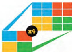
Conversione delle immagini 320 x 240 in immagini 640 x 480, ovvero risoluzione e pixel 4 volte maggiori con SuperResolution.
