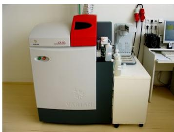
Lo sviluppo della spettrometria a plasma accoppiata alla spettrometria di massa (ICP-MS) nel campo dell'analisi ambientale è dovuto all'elevato numero di elementi che questa tecnica consente di
