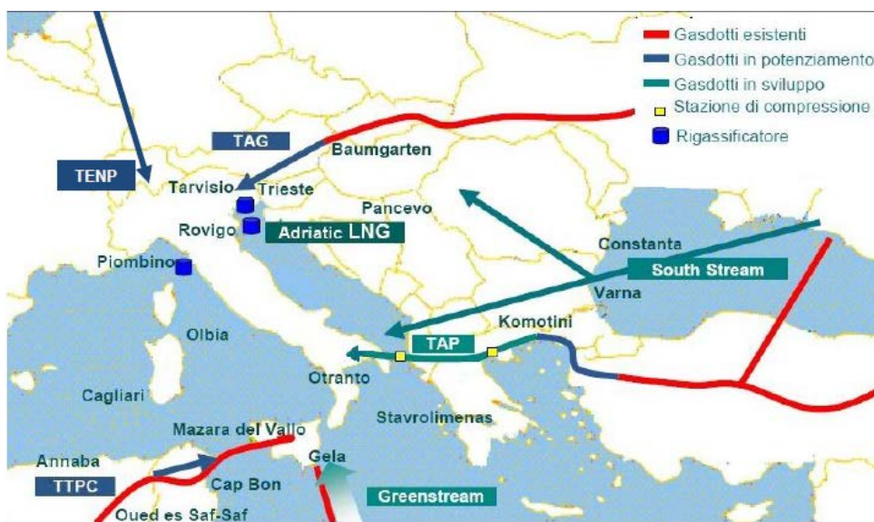
Fig. 8 - Rappresentazione schematica dei gasdotti esistenti e in costruzione in Europa
