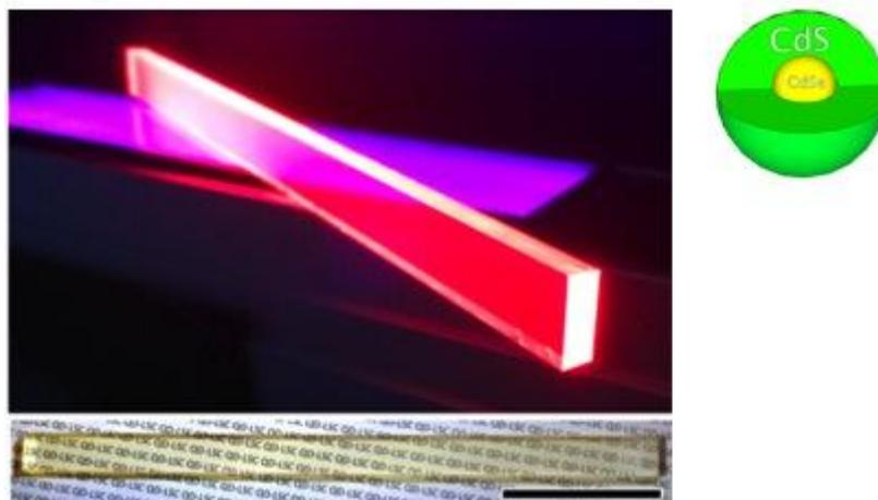
Fig. 4 - Dimostratore di concentratore luminescente a base di quantum dots *core-shell* CdSe/CdS
