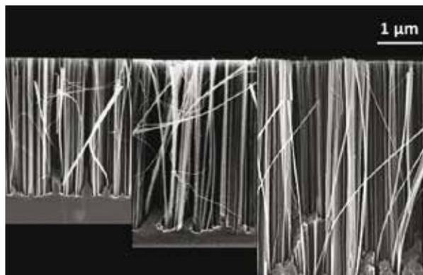
Fig. 1 - Immagini SEM di SiNW di differente lunghezza
