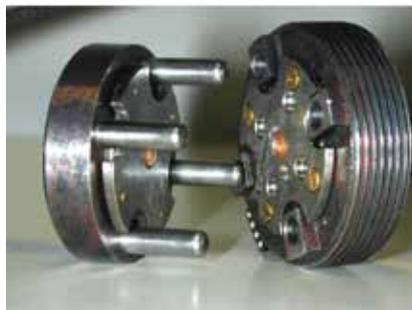
Schema della cella a incudine di diamante che permette di ottenere pressioni di centinaia di GPa. Due diamanti sono affacciati dalla parte delle facce piccole attraverso una guarnizione metallica che confina lateralmente il campione
