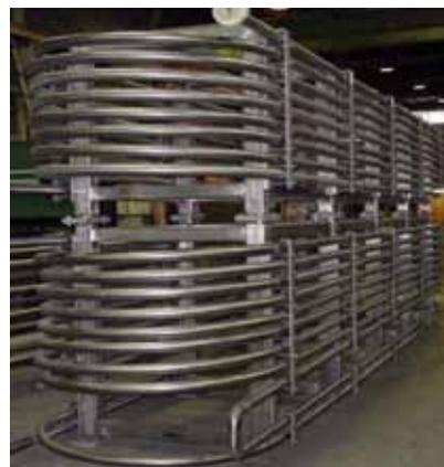
Viste del reattore di tipo “plug flow” tubolare tubo in tubo
