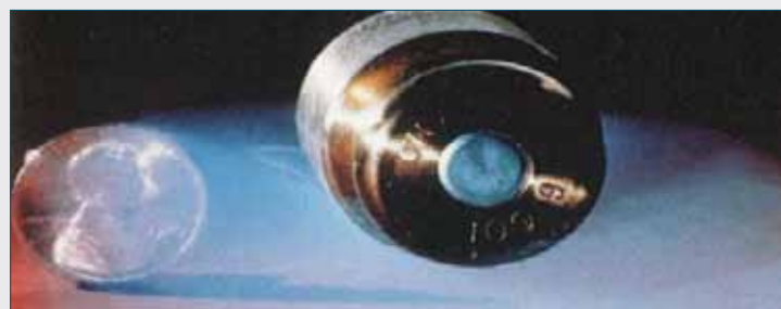
Fig. 4 - Campione di aerogel composto da microfibre di silice. Si nota il colore trasparente un peso di 0,7 g e capace di sostenere uno di 100 g
