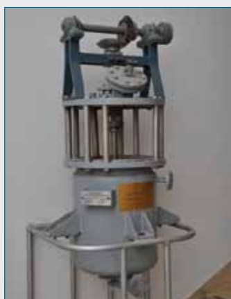
Fig. 1 - Il primo reattore di polimerizzazione Wacker
