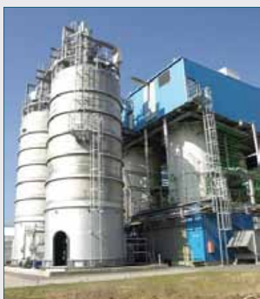
Fig. 2 - I reattori di polimerizzazioni di oggi di Vinnolit, l'evoluzione industriale di Wacker
