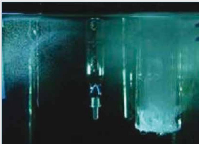
Evoluzione di bolle di ossigeno all'anodo (a sinistra) e di idrogeno al catodo (a destra) in cella per fotoscissione dell'acqua
