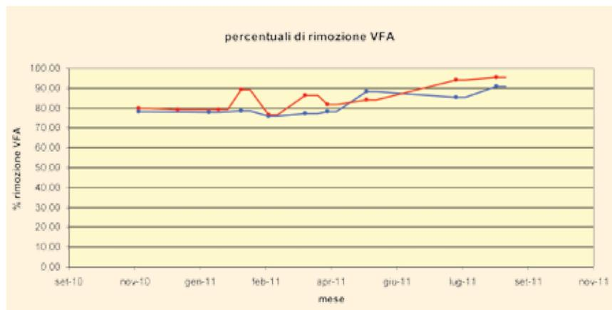
Nel secondo grafico si riportano le percentuali di abbattimento degli acidi organici prodotti in idrolisi e consumati in metagenesi. Come si può notare, l'abbattimento è decisamente elevato (oltre il 90%) e indica la presenza di una buona e stabile popolazione batterica metanigena in grado di assorbire e consumare gli acidi prodotti.
