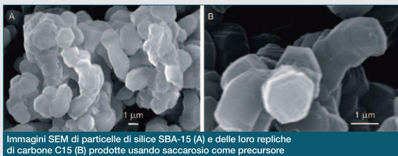
Immagini SEM di particelle di silice SBA-15 (A) e delle loro repliche di carbone C15 (B) prodotte usando saccarosio come precursore
