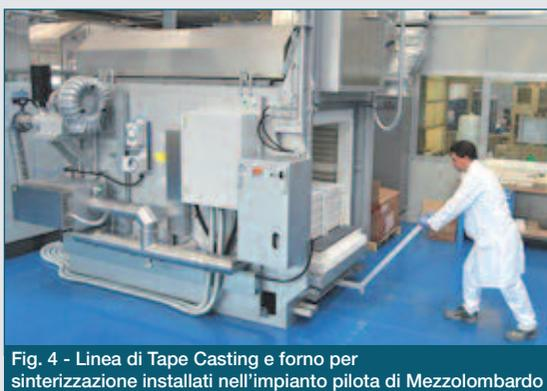
Fig. 4 - Linea di Tape Casting e forno per sinterizzazione installati nell'impianto pilota di Mezzolombardo
