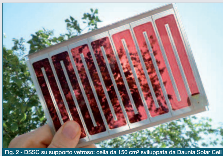
Fig. 2 - DSSC su supporto vetroso: cella da 150 cm² sviluppata da Daunia Solar Cell
