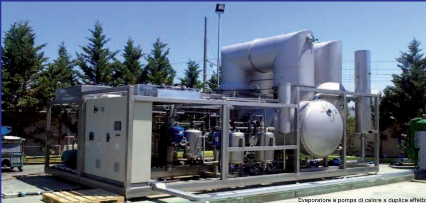
Evaporatore a pompa di calore a duplice effetto
