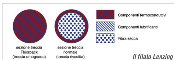
Fluorpack®, interamente realizzato con fibre Lenzing®, è una treccia messa a punto da **Texpack** e composta da filati di PTFE espanso con particelle di grafite incapsulate e di componenti dotati di potere lubrificante, atti a condurre calore apportando un'elevata conducibilità termica, resistenza agli agenti chimici e all'invecchiamento. Tale struttura omogenea consente alla treccia di non rilasciare i
