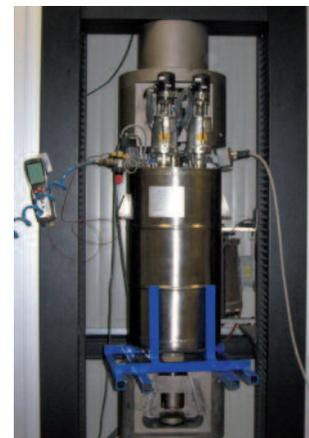
Criostato azoto/elio per prove trazione a 4°K
