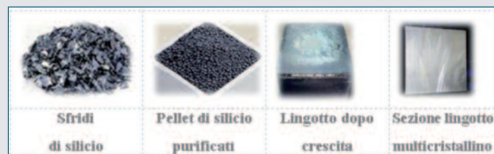
Fig. 8 - La trasformazione del silicio: dallo sfido al lingotto multicristallino
